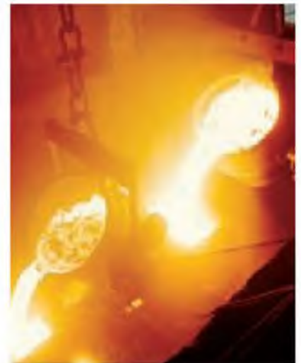
▲ Figura 6.6 El color como una función de la temperatura. El color e intensidad de la luz emitida por un objeto caliente depende de la temperatura del objeto. La temperatura es mayor en el centro de este flujo de acero fundido. Como resultado, la luz emitida desde el centro es más intensa, y tiene una longitud de onda menor.
